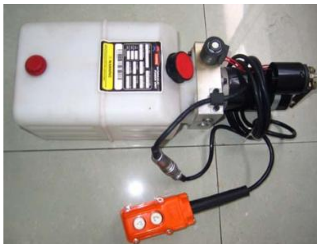
استفاده از موتور DC به عنوان محرک پمپ
